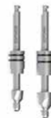
Preparatori di spalla Si dovrà scegliere il preparatore di spalla corretto in funzione della famiglia di impianti (A o B) da inserire. Non sono stati previsti stop meccanici al contatto con la boccia e dunque è importante riferirsi alle tacche di profondità incise laser sullo strumento.
