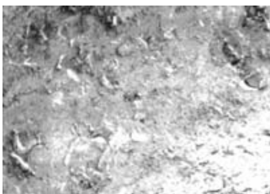
Figura 7. Micrografia di un impianto in titanio sabbato (x500)
