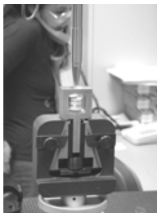
Figura 23. Afferraggi inferiore e superiore che fissano il blocchetto in resina per la prova di trazione, al fine di determinare il distacco dell'impianto dall'osso
